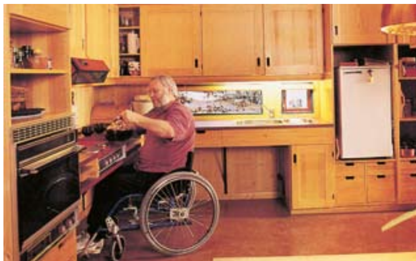
Fig 3. L-formet kjøkkeninnredning og plass til bena under arbeidsbenk, komfyrtopp og vask. Skap og skuffer uten knotter gjør at klær ikke blir hengende fast. Lite luftvindu på 40x40cm, lett tilgjengelig.
